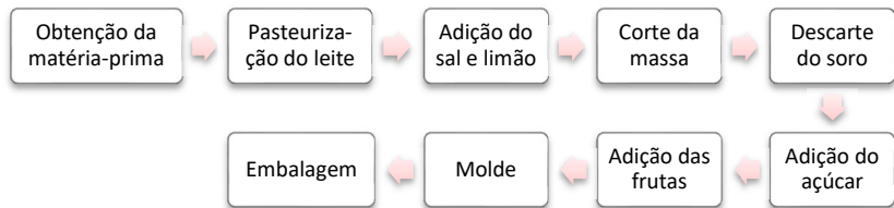
Figura 1. Fluxograma do processamento de queijo ricota com frutas cristalizadas.
