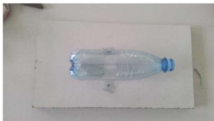
Figura 2. Garrafa PET fixada do suporte de madeira. Fonte: Autores, 2016.
