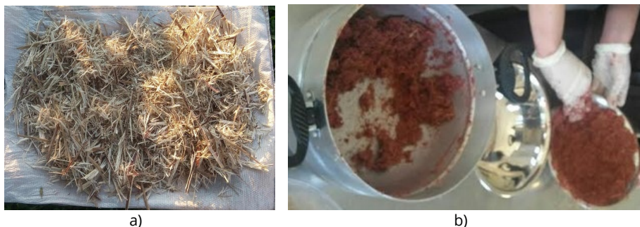
Figura 1. (a) Secagem do bagaço. (b) Produção da massa de cana-de-açúcar e produto de “colagem”.
