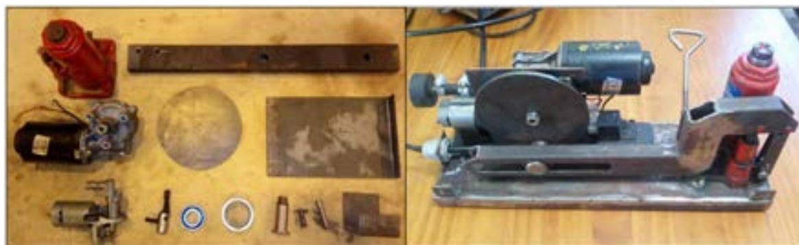
Figura 1. Principais componentes reciclados e montagem conjunto
