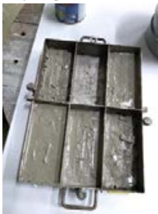
Figura 2 - Tijolos já dispostos nas fôrmas para a secagem
