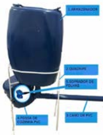
Figura 1 – estrutura completa do Alimentador Automatizado para Peixes
