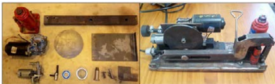
Figura 1. Principais componentes reciclados e montagem conjunto
