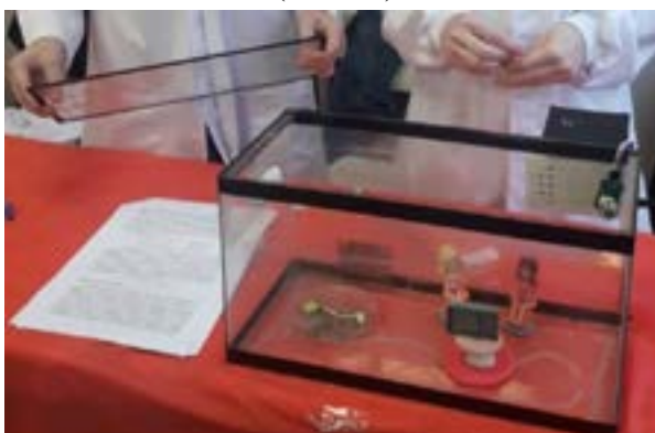
Figura 1 – Ambiente confinado utilizado para detecção de gás carbônico com sensor de célula sólida (MG811)
